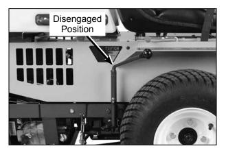
**Blade Clutch Disengaged**
